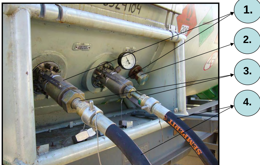
1 – Запорная арматура контейнера, 2 – Уровнемерное устройство, 3 – Переходные устройства налива, 4 – Заливные шланги.
